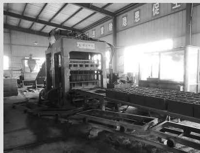
混凝土小型空心砌块生产
