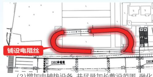
(2)增加电辅热设备,并尽量加长敷设范围,融化冰雪,烘干路面。
