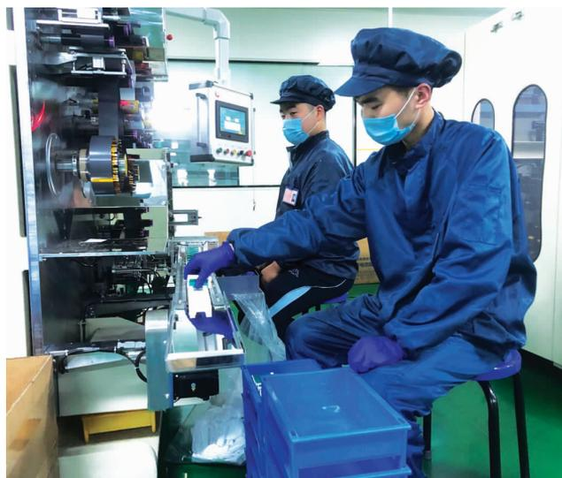
高新区总投资2亿元的润远锂电储能电池系列产品研发、生产项目于今年初竣工投产,新上的2条锂电池电芯生产线日生产锂电池10万只,目前主要为高新区40多家灯具龙头企业配套。图为公司生产场景。
