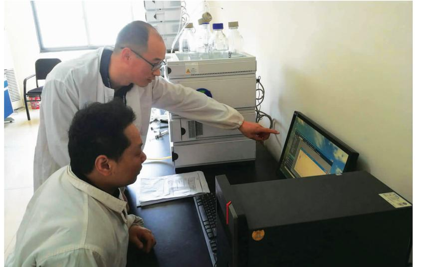
图为朱万伟指导企业员工在氨糖实验室进行液相色谱检测。
