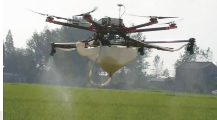
右图为高飞研制的农用植保无人机正在喷洒农药。下图为高飞正在操纵自制农用植保无人机进行农药喷洒。
