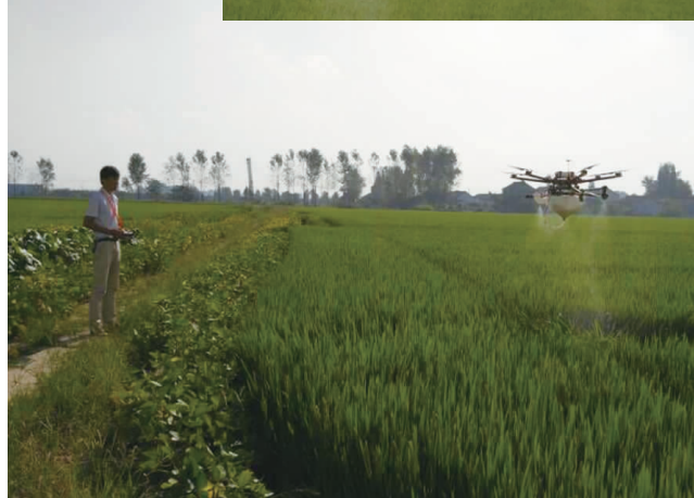
右图为高飞研制的农用植保无人机正在喷洒农药。下图为高飞正在操纵自制农用植保无人机进行农药喷洒。
