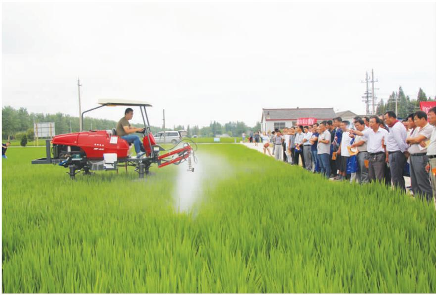
近几年,随着经济的快速发展,植保机械也不断更新,担架式弥雾机、自走式喷杆喷雾机、植保飞行器逐渐被农民认可并采用,减轻农民劳动强度的同时,也提高了病虫害防治效果和效率。
