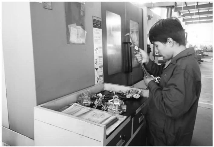
车逻镇高袁机械公司2010年与美国MOOG公司合作,专业生产民用飞机用的伺服阀阀体、阀芯、阀套部件等。今年以来,该公司订单不断,产销两旺。图为工人在数控车床前检验生产出来的机械零部件。玉梅摄
